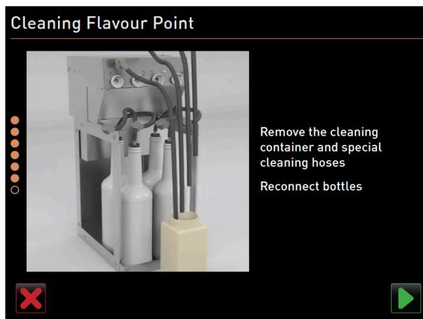
Abb.: Reinigungsbehälter wieder entfernen
