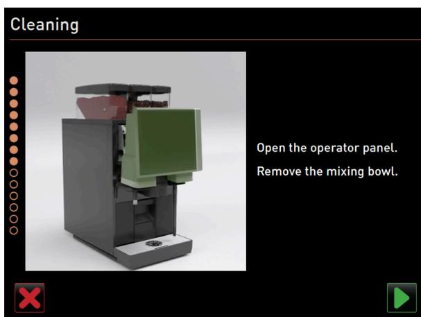
Abb.: Bedienpaneel anheben
