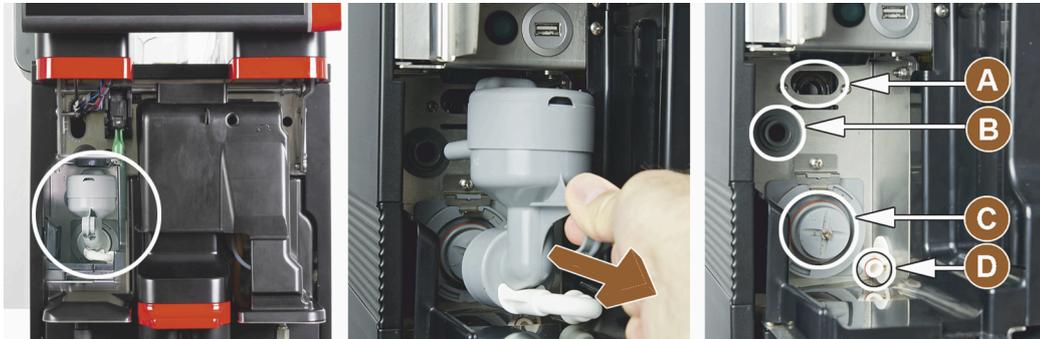
Abb.: Bedienelemente am Mixerbecher zu Pulver- oder Toppingsystem (Option)
