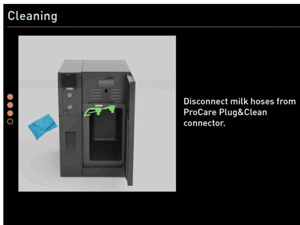
Abb.: Milchschräuche von **Plug&Clean**-Anschlüssen entfernen
