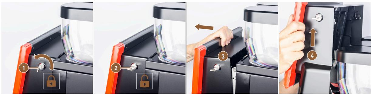
Abb.: Bedienpaneel öffnen
